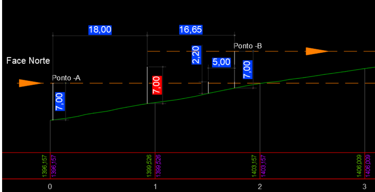
Img07 – Perfil longitudinal do Talhão 01
