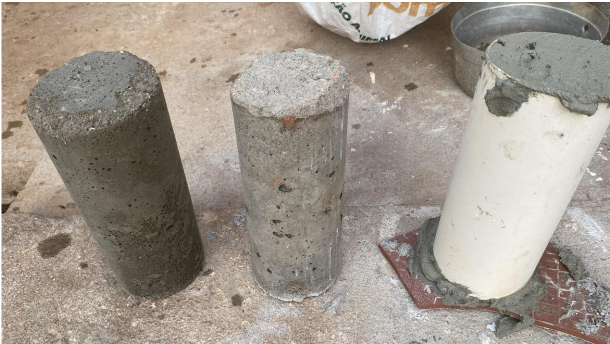
Figura 1 - Imagem dos tarugos de concreto com diferentes proporções de água.
