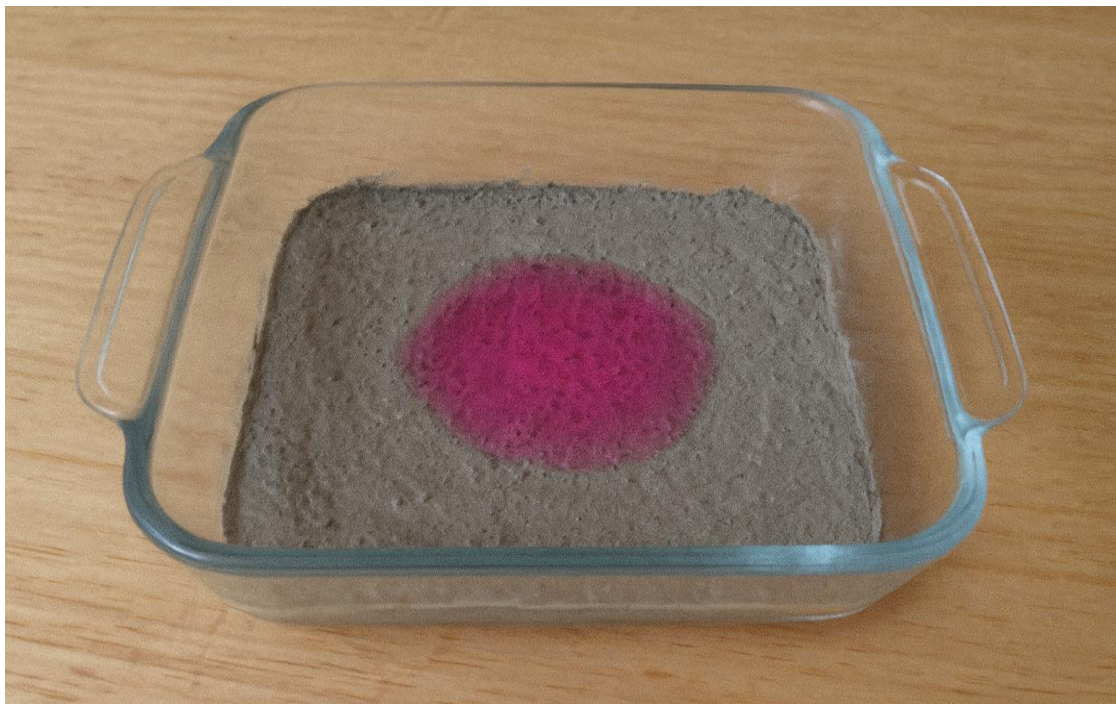
Figura 3 – Imagem ilustrativa do cimento com coloração vermelha indicando pH básico
