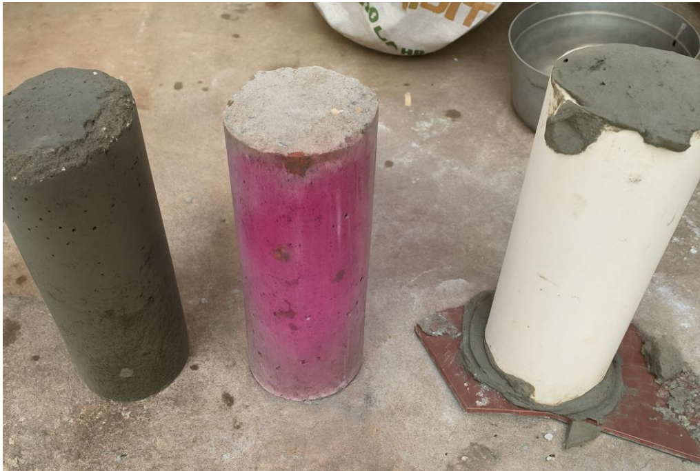
Figura 4 -Imagem ilustrativa do Tarugo de cimento com coloração vermelha indicando pH básico
