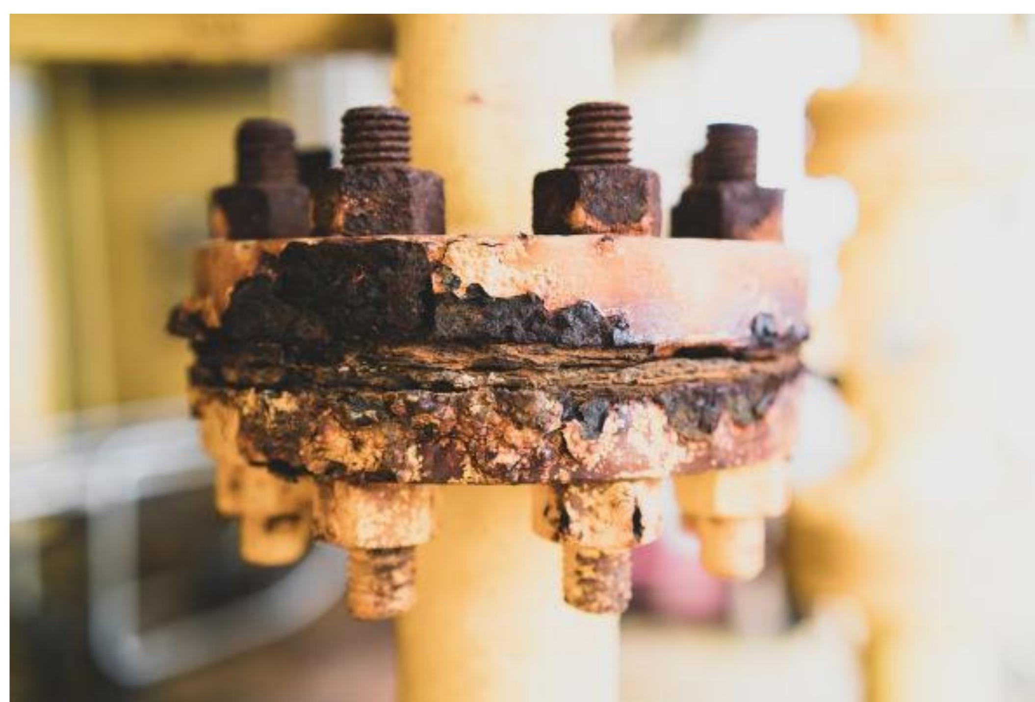
Figura 3: A corrosão ocorre naturalmente em metais expostos ao oxigênio do ar e à umidade. (Fonte: Mundo Educação)
