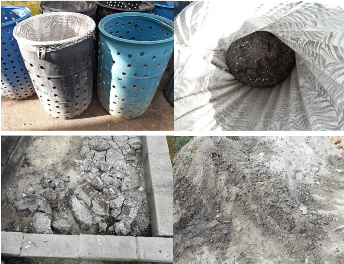
Imagem 4- Tratamento do lodo: A- baldes para o escoamento do liquido. B- Bolo do lodo. C- Lodo seco. D- as cinzas do lodo
