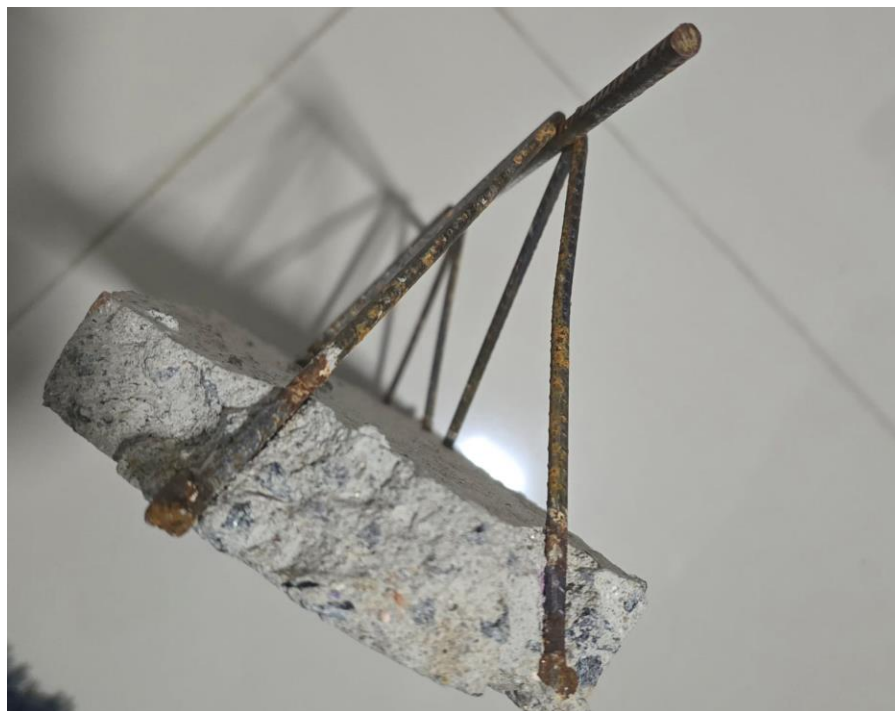
Foto 2 – Amostra de concreto antes da aplicação da fenolftaleína
