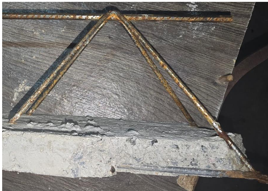
Foto 4 – Amostra de concreto antes da aplicação da fenolftaleína
